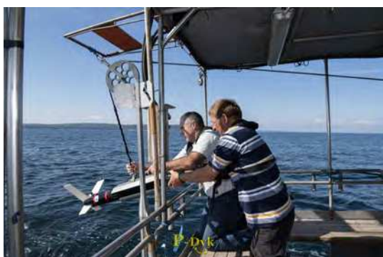
Sonaren på väg ner i vattnet. Foto: P-Dyk
